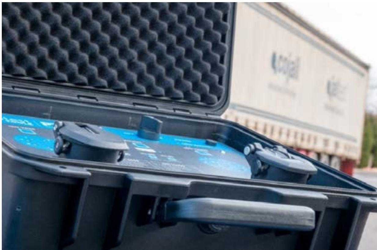
Bei Benützung von Jaltest PTE als Stromquelle des gezogenen Fahrzeuges ohne Notwendigkeit einer Zugmaschine, kann mit dem Diagnosetool von Jaltest Kontakt mit den Systemen mit elektronischer Kontrolle aufgenommen werden.
