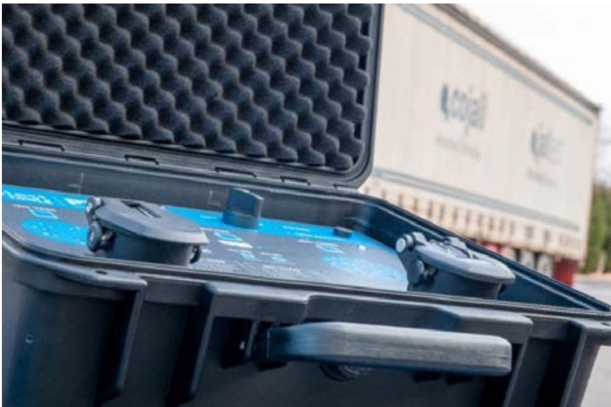
Utilizando Jaltest PTE como fuente de alimentación del vehículo remolcado y sin necesidad de disponer de una cabeza tractora, puede conectar en los sistemas con control electrónico con la herramienta de diagnóstico Jaltest.
